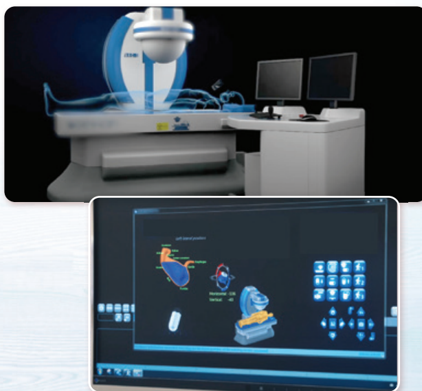
膠囊內窺鏡磁控儀器（鳴謝黃醫生提供照片）
